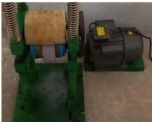
Рис. 2. Экспериментальный стенд валковой отжимной машины
