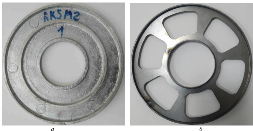
Рис. 1. Междупильные прокладки линтерной машины: a – AK5M2; б – Сталь 3
